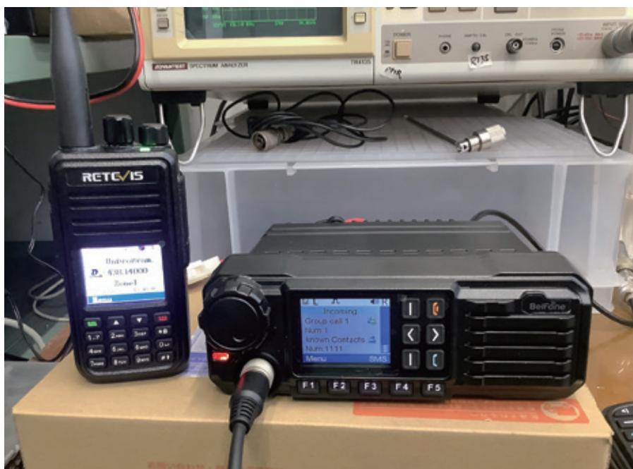
↑写真6 / 海外製のDMR対応トランシーバー。144/430MHz機で、FM運用も可能。
